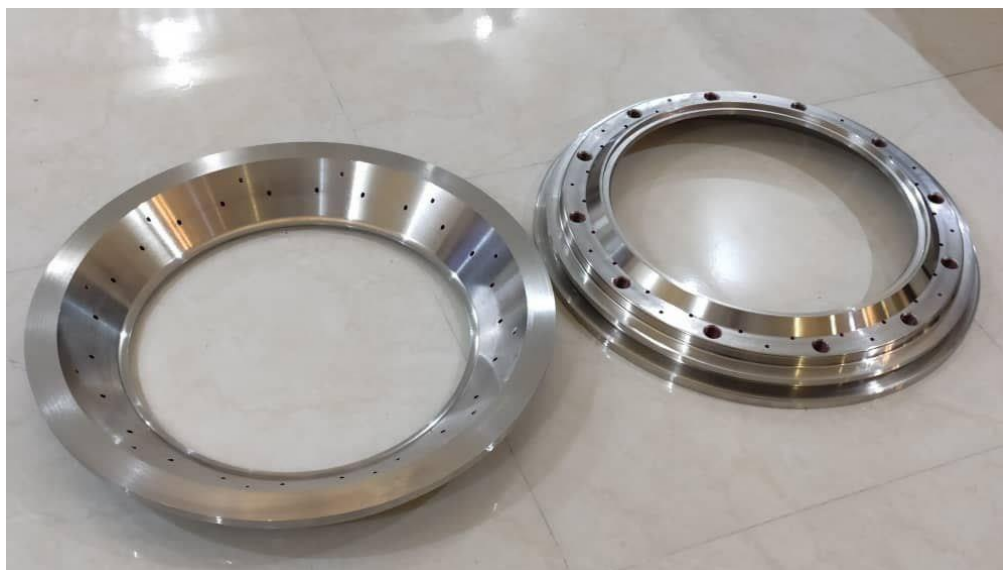
نمونه اینزرت رینگ تولید شده (قطعه‌ی فاینال)
