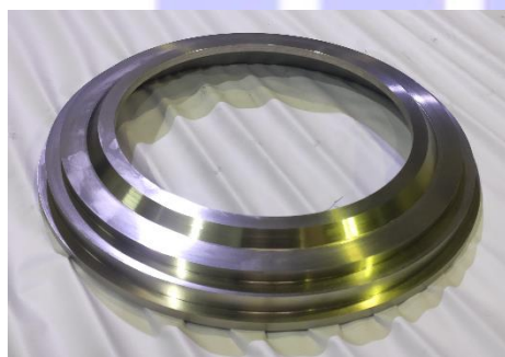
نمونه اینزرت رینگ تولید شده ( پس از خشن کاری )
