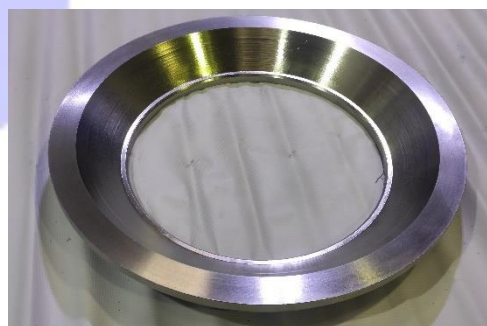
نمونه اینزرت رینگ تولید شده ( پس از خشن کاری )
